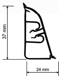
Плинтус для столешниц AP740 с технологией нанесения декора «hot stamping». Данная технология позволяет получить наиболее приближенный к столешнице декор при сохранении максимальной устойчивости к влаге, царапинам, тепловому воздействию. Плинтус для столешниц AP740 имеет специальные уплотнители, предохраняющие от проникновения влаги и грязи. К плинтусу имеется полный комплект аксессуаров.
